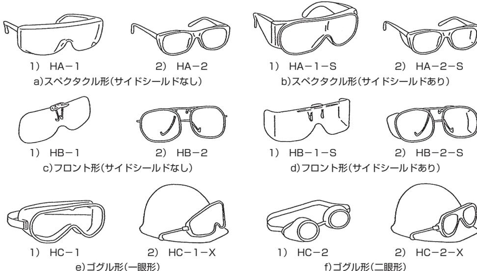
図 1- 保護めがねの形状 (図は一例を示す。)
